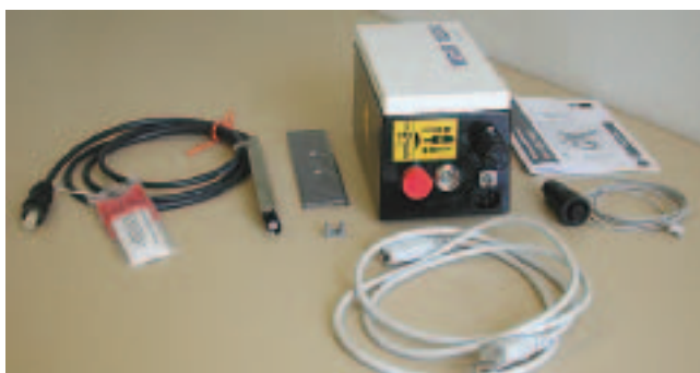
Комплект набора для снятия электростатического заряда с образцов и тары (блок питания, электрод, кабели)
